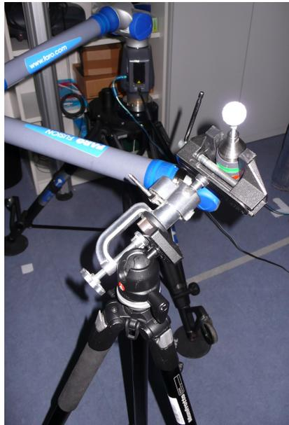
Abbildung 8.4: Befestigung der Kombination aus einem FaroArm und einer Markerkugel mit Hilfe eines Stativs
