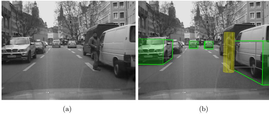
Abbildung 1.1: Beispiel einer Überlagerung der Realität mit virtuellen Inhalten: (a) zeigt das unveränderte Bild aufgenommen mit einer Video Kamera; (b) zeigt das gleiche Bild, aber zusätzlich mit augmentierten Sensordaten des Fahrzeugs
