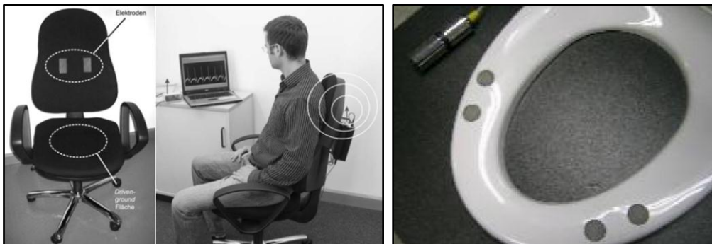
Abbildung 3-12: Systeme zur Erfassung von Vitalparametern eingebettet in der Umgebung. Links: Aachen Smart Chair, entnommen aus (Aleksandrowicz et al. , 2007). Rechts: Toilettensitz mit eingebetteten Elektroden zur Messung von EKG und Körperimpedanz, entnommen aus (Nam et al. , 2007).
