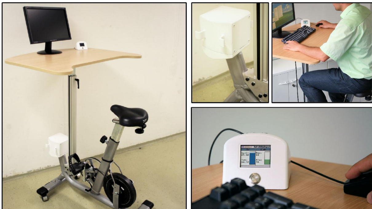
Abbildung 6-4: Prototypische Realisierung des aktivitätseingebetteten Präventionsmoduls zur Durchführung von Sport am Arbeitsplatz. Links: Modul im Überblick. Oben links: Detailansicht der Schaltbox mit VESA Halterung. Oben rechts: Nutzungsszenario. Unten rechts: Detailansicht des Anzeigemoduls.
