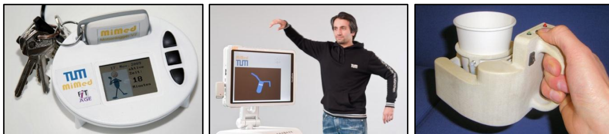
Abbildung 3-10: Auswahl der am Lehrstuhl MiMed entwickelten tragbaren oder textilen Assistenzsysteme. Links: Motionlogger, eingesteckt in Dockingstation zur Datenausgabe (© TUM-MIMED, 2010). Mitte: Pullover zur Bewegungserfassung, entnommen aus (Niazmand et al. , 2010). Rechts: Cup Holder zum Tremorausgleich, die Lage der Beschleunigungssensoren ist gekennzeichnet (© TUM-MIMED, 2010).
