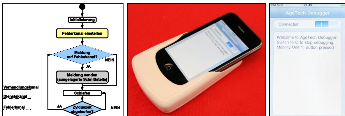
Abbildung 6-14: Prototypische Realisierung eines Funkdebuggers. Links: im Fehlerempfangsgerät ablaufender Prozess. Mitte: Verwaltungseinheit gekoppelt mit einem iPhone (Apple), auf dem die Fehlerdarstellungssoftware ausgeführt wird. Rechts: Bildschirmfoto der Fehlerdarstellungssoftware.
