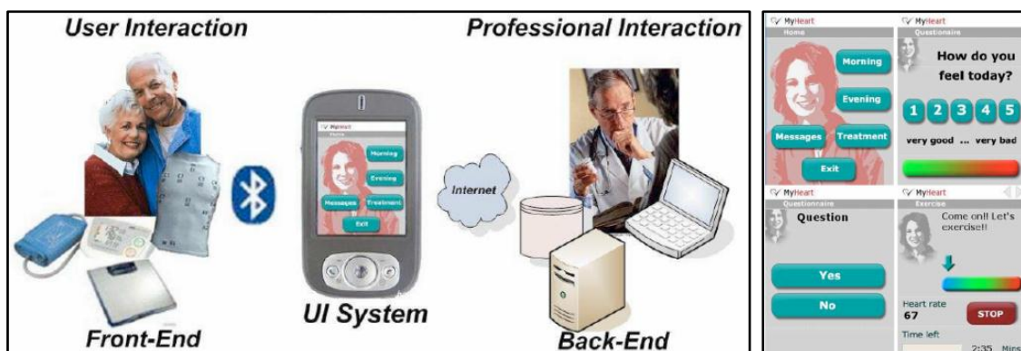
Abbildung 3-9: Beispiel eines Assistenzsystems zur Überwachung von Herz-Kreislauf Erkrankungen. Links: Gesamtkonzept, entnommen aus (Villalba et al. , 2006). Rechts: Schnittstelle zur Nutzerinteraktion, entnommen aus (Villalba et al. , 2006).
