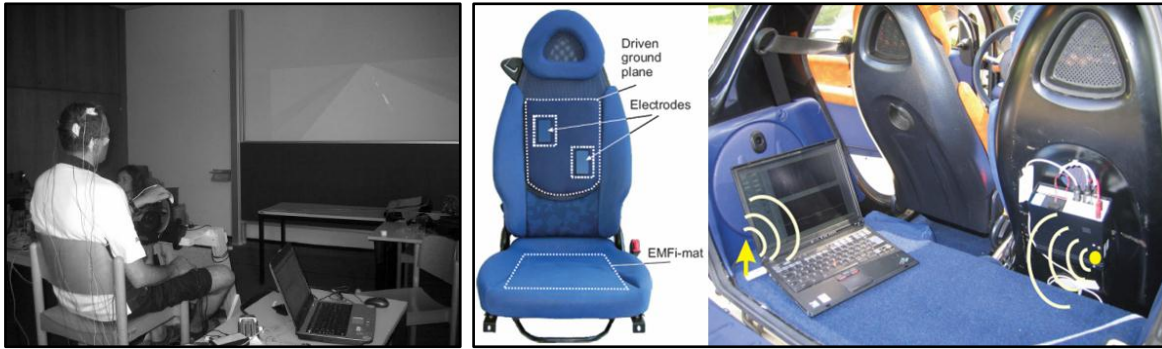
Abbildung 3-11: Systeme zur Erfassung von Vitalparametern im Automobil. Links: System zur Erfassung von Vitalparametern während simulierter Fahrten, entnommen aus (Zocchi et al. , 2007). Rechts: Im Sitz eingebettete Elektroden (Leonhardt & Aleksandrowicz, 2008).
