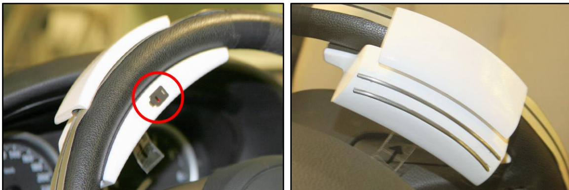
Abbildung 6-2: Prototypische Realisierung des aktivitätseingebetteten Präventionsmoduls zur Messung von Vitalparametern im Automobil (lenkradexterne Variante). Links: Puls-oximetriesensor (im Kreis). Rechts: Elektroden zur Erfassung des Hautleitwerts.
