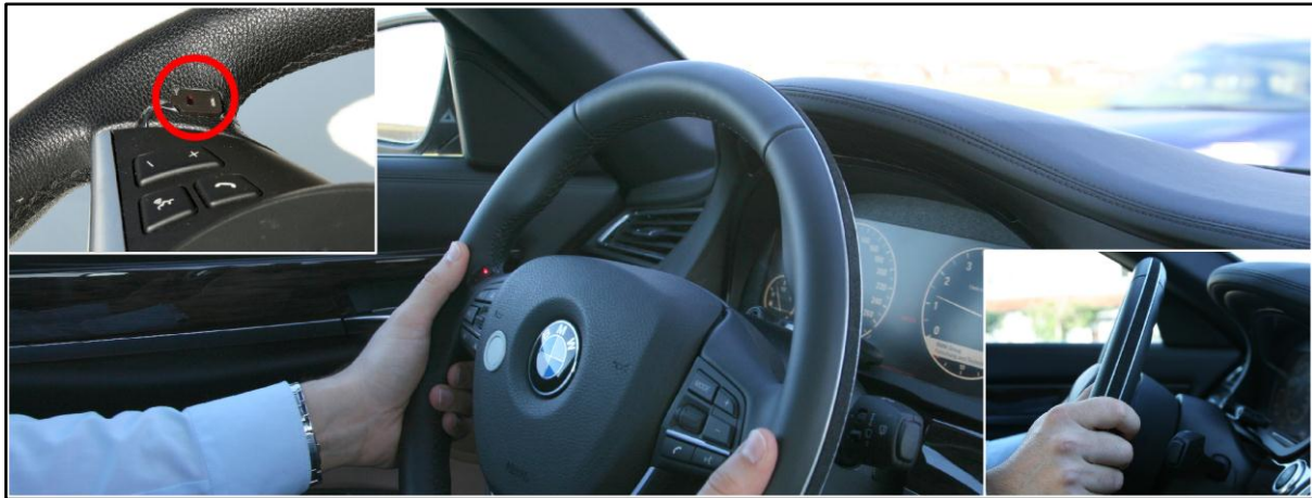
Abbildung 6-1: Prototypische Realisierung und Nutzungsszenario des aktivitätseingebetteten Präventionsmoduls zur Messung von Vitalparametern im Automobil (lenkradinterne Variante). Links oben: Puls-oximetriesensor (im Kreis). Rechts unten: Detailansicht der Elektroden zur Erfassung des Hautleitwerts.
