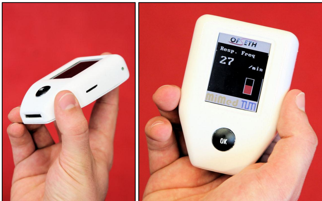
Abbildung 6-6: Prototypische Realisierung der Verwaltungseinheit mit integrierter Nutzerschnittstelle und Universalbuchse zum Anschluss einer ausgelagerten Nutzerschnittstelle. Links: Die Universalbuchse und der Entnahmeschlitz für die Mikro-SD Karte an der Seite des Gehäuses sind gut sichtbar. Rechts: Draufsicht während der Anzeige einer empfangenen Atemfrequenz.
