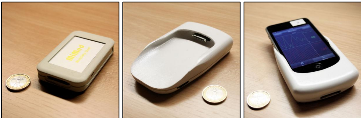
Abbildung 6-13: Prototypische Realisierung von Verwaltungseinheitskernen ohne integrierter Nutzerschnittstelle. Links: fahrzeugintegrierte Verwaltungseinheit. Mitte: Verwaltungseinheit mit integrierter Telefonschnittstelle. Rechts: Verwaltungseinheit mit integrierter Telefonschnittstelle gekoppelt mit einem iPod (Apple), auf dem die ausgelagerte Nutzerschnittstelle ausgeführt wird.
