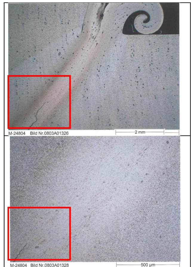
Abbildung 20: Schrumpfrisse nach einer Kegelschweißung IN718-IN718
