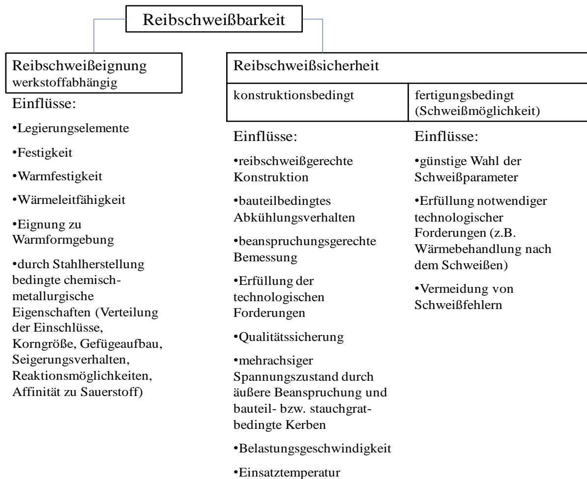
Abbildung 4: Einflussfaktoren auf die Reibschweißbarkeit nach [29]
