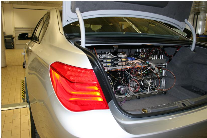
*Abbildung 6.21.: In einem Fahrzeugdemonstrator integriertes Schattennetz.*
