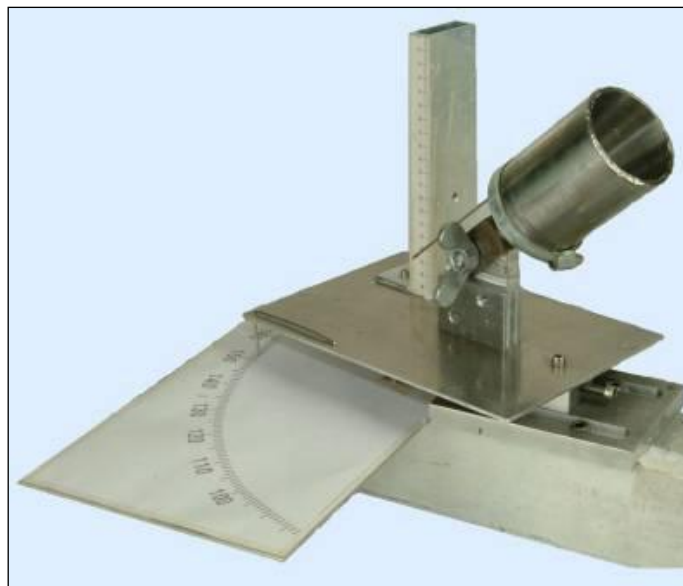
Abbildung 33 Femoralseitiges Rotationsgelenk für Varus-/Valgus-Bewegungen in koronarer Ebene.
