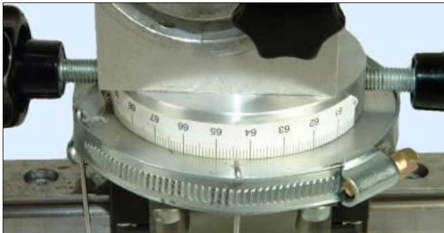
Abbildung 34 Tibialseitiges Rotationsgelenk für Varus-/Valgus-Bewegungen in koronarer Ebene.
