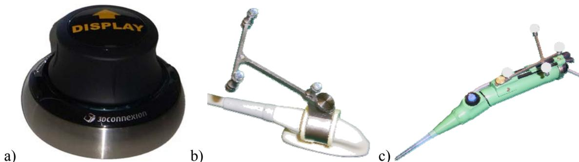
Abbildung 16: Komponenten des Systems: a) 6D-Maus, b) Ultraschallsonde mit Lokalisator und c) Handstück des Resektionsinstrumentes mit Lokalisator.
