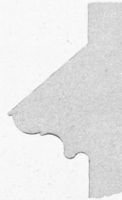
14. Gesims an der Galerie des Süd Portals.
