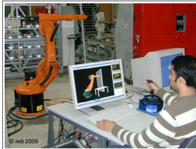
Abbildung 2.4: TPTA-System zur Handhabung schwerer Lasten (Quelle: REINHART & RADI 2008)
