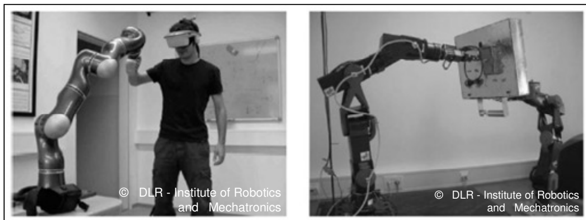
Abbildung 2.3: Versuchsstand des DLR für den Einsatz von telepräsent gesteuerten Robotern in Weltraumstationen (Quelle: STOLL et al. 2009)
