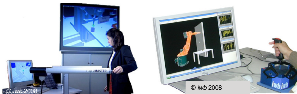
Abbildung 4.2: Virtuelle Mikromontage mit dem Haptic Master (links), virtuelle Roboterarmontage mit dem Immersion Joystick (rechts)
