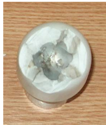
Abbildung 5.5: Beschädigte Elektrode (Elektroden­durchmesser 30 mm; Beschichtungsdicke 8 mm; Abstand der blanken Elektroden 25 mm; n = 30 ; SF 6 ; Druck 0,4 MPa; LI; SSV; \Delta u = 20 kV)
