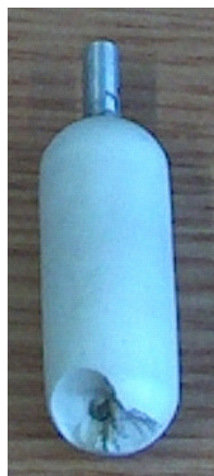
Abbildung 5.8: Beschädigte Elektrode (Elektrodendurchmesser 4 mm; Beschichtungsdicke 3 mm; Abstand der blanken Elektroden 25 mm; n = 30 ; \text{SF}_6 ; Druck 0,4 MPa; LI; SSV; \Delta u = 20 kV)
