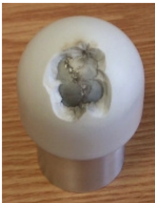
Abbildung 5.4: Beschädigte Elektrode (Elektroden­durchmesser 30 mm; Beschichtungsdicke 3 mm; Abstand der blanken Elektroden 25 mm; n = 30 ; SF 6 ; Druck 0,4 MPa; LI; SSV; \Delta u = 20 kV)
