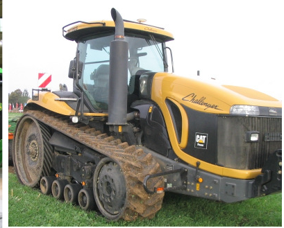
AGCO Challenger MT700 und MT800 2 keilförmige kraftschlüssige Gummibandlaufwerke
