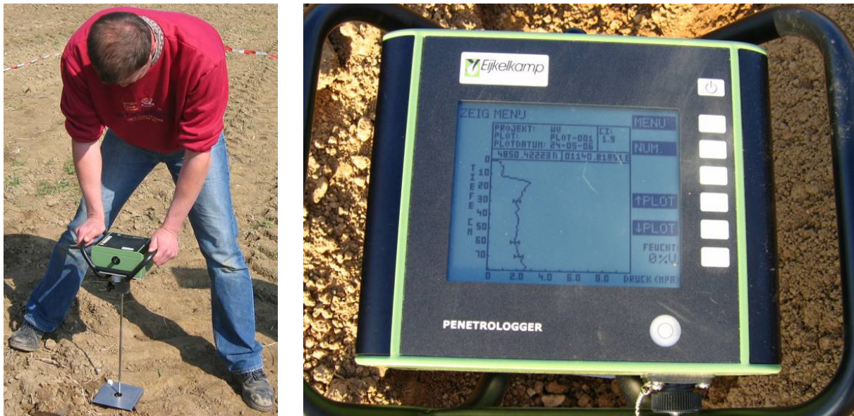
Abb. 49: Einsatz des Penetrometers zur Messung des Eindringwiderstandes
