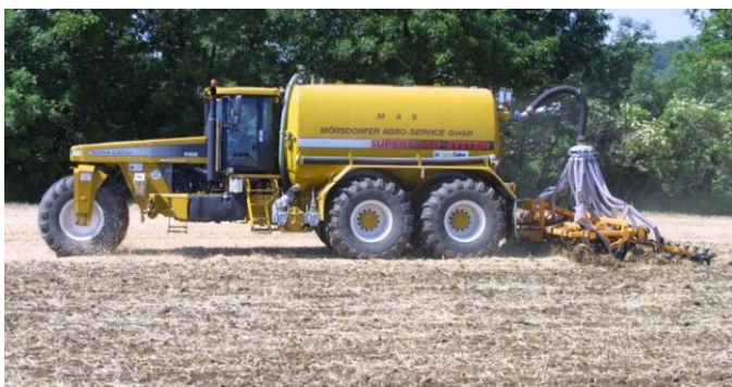
5-Radmaschine nach Dreiradkonzept mit Tandemhinterachse und einem einzelнем großvolumigem Rad mit Drehschemellenkung in Front
