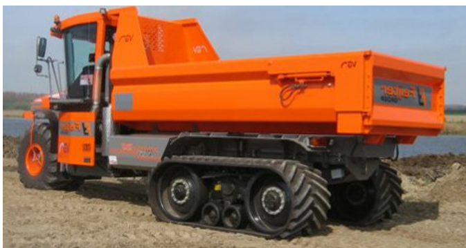
Dreiradkonzept kombiniert mit Raupenlaufwerk anstelle der Hinterachse (Halbraupe)
