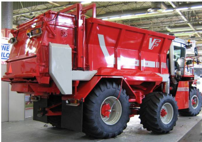
Teleskopierbare Mittelachse zur ganzflächigen Überrollung bei der Fahrt im Feld
