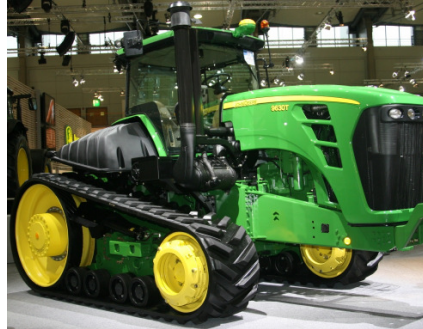
John Deere T 8000 und T 9000 2 keilförmige kraftschlüssige Gummibandlaufwerke
