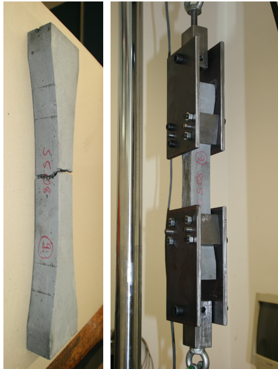
Bild 5.10: Versuchseinrichtung für den zentrischen Zugversuch an UHPC-Körpern
