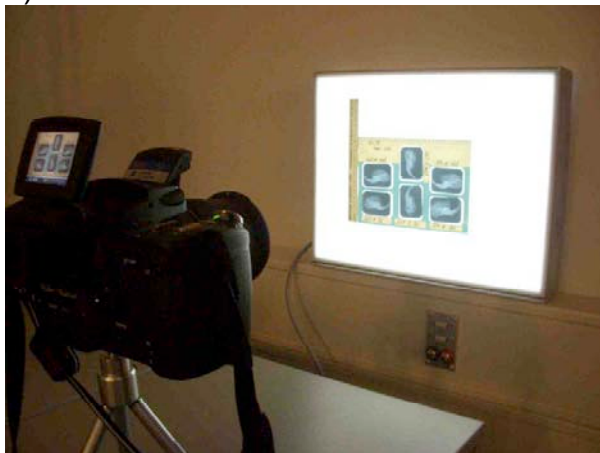
Abb. 4-6 Radiologische Untersuchung a) Verfahren zum Fotografieren der radiologischen Bilder auf dem Röntgenbe- trachtungsschirm b) Rasterschablone im Defektbereich
