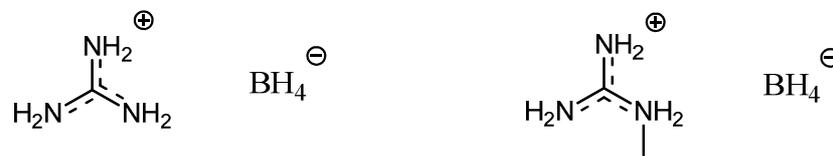
Schema 32: Strukturformeln von Guanidinium und Methylguanidinium Borhydrid.
